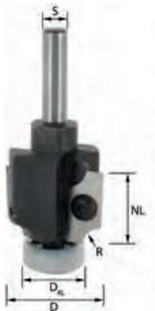
Zweischneidige Fräserkombination mit zwei Größen an Kugellagern und somit als Abrundfräser und/ oder Viertelstabfräser verwendbar. Durch den einfachen Wechsel des Anlaufkugellagers kann das Profil angepasst werden. Mit Wende- bzw. Wechselplatten bestückt.
