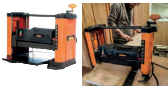
Dickenhobelmaschine mit einfacher und präziser Höhentiefeneinstellung in 1,6 mm-Schritten.
