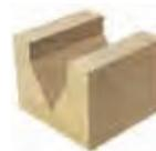
Mit V-Nutfräsern lassen sich Ziernuten, sowie V-Nuten in alle Holzarten und Plattenwerkstoffe fräsen. Die 60°-Fräser lassen sich ebenso gut als Schriftenfräser verwenden. V-Nut- und Schriftenfräser können gut zum Anfasen von Harthölzern und Plattenwerkstoffen eingesetzt werden. Der Nutgrund ist etwa 1 mm breit und flach.
