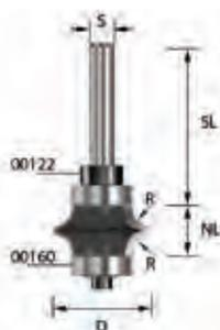
Spitzenkantenfräser HM Z2 mit zweierlei auswechselbarem Kugellager (D = 16 mm) oben und unten.
