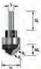
Zum Fräsen von Profalnuten im klassischen Stil mit gerundeter Bohrschneide und Kugellager am Schaft für Arbeiten mit Schablone. Mit seinen HM-Schneiden auch zum Einbohren geeignet.
