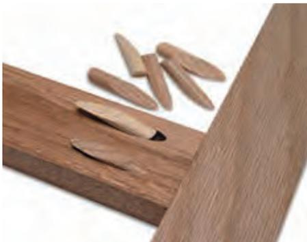
Hochwertige Massivholzdübel zum Verschließen von Taschenlochbohrungen. Ideal für den Einsatz bei **Materialstärken von 12,7 bis 38 mm**. Einfach Leim auftragen, in die Bohrung schieben, trocknen lassen und bündig abschleifen.
