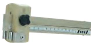
Präzise gefertigtes Doppelstreichmaß von E. C. Emmerich mit zwei Anreißstäbchen aus Weißbuche. Bequem per Sternschrauben (2x) arretierbar. Gut ablesbare mm-Skalen und schlanke Anreißnadeln aus Stahl.
