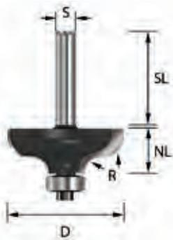
Zweischneidiger Hartmetall Karnisfräser mit auswechselbarem Kugellager.
