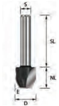
Der Fase-Bündigfräser kann gleich zwei Aufgaben auf einmal verrichten. Anfasen und bündig fräsen. Der Fräser ist unten schneidend und somit zum Einbohren geeignet.
