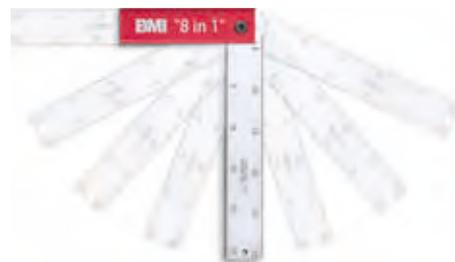
Der Schreiner- und Gehrungswinkel aus dem Hause BMI macht sich klein für Taschen und Werkzeugkoffer. Es lassen sich die klassischen acht Winkel präzise einrasten: 0°, 22,5°, 45°, 67,5°, 90°, 112,5°, 135° und 157,5°. Die Millimeter-Skalen sind auf der Edelstahlzunge beidseitig geätzt. Die Rastwinkel sind auf dem eloxierten Griff eingelasert. Praktisch für die Zollstocktasche, perfekt für die Werkzeugkiste!
