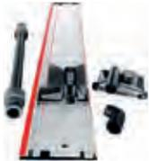
Das Saug-Spannsystem Aerofix nutzt die Saugkraft des Staubsaugers und erzeugt so zwischen Führungsschiene und Werkstück einen Unterdruck, damit die sichere Führung auch ohne Zwingen gewährleistet ist. Sobald der Sauger eingeschaltet wird, ist auch die Führungsschiene fixiert!
