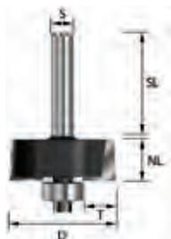
Zweischneidiger Falzfräser mit ziehen-dem Schnitt und auswechselbarem Kugellager.
