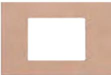
MDF-Schablone zum Ausfräsen für alle Einlegeplatten mit den Maßen 306 x 229 mm
