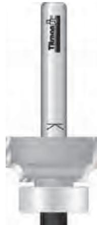
Diese speziellen Abrundfräser eignen sich durch die verlängerten Schneiden besonders gut für Werkstücke mit Klebstoffresten, da hier ein Festsetzen des Klebstoffes zwischen Anlauflager und Schneide vermieden wird. Für empfindliche Materialien empfehlen wir zudem Kunststoff ummantelte Kugellager (siehe unten).
