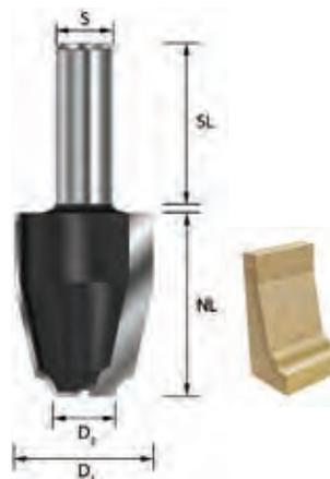
Der zweischneidige Abplattfräser mit Radius 4 mm wird zur vertikalen Bearbeitung von Werkstücken verwendet. Der vertikale Abplattfräser erreicht bei kleinerem Durchmesser eine größere Abplatttiefe. Besonders geeignet ist der Fräser, wenn die Bearbeitung durch eine Oberfräse mit kleinerer Öffnung erfolgt. Die Arbeitstiefe von 41,3 mm sollte hierbei in 2 bis 3 Arbeitsschritten durchgeführt werden.
