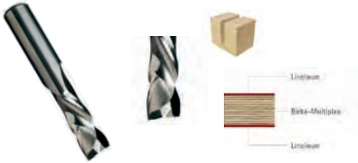
Der Fräser mit geschliffener Spirale garantiert einen optimalen Spanauswurf. Die spiralförmig geschliffene Schneide erzeugt beim DUALCUT einen sowohl ziehenden Schnitt (Linksdrall) als auch einen schnelleren Durchzug (Rechtsdrall). Der Linksdrall der Fräuserschneiden bewirkt eine saubere Nutkante, der Rechtsdrall einen sauberen Nutgrund. Der DUALCUT ist somit der perfekte 2in1-Spiralnutfräser.
