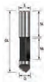
Ausstech- und Kopierfräser werden insbesondere zum Ausfräsen von Ausschnitten, zum Konturfräsen sowie zum Kopierfräsen mit der Handoberfräse verwendet. Die Fräser sind ausgestattet mit einer HW (HM)-Umfang- und Bohrschn
