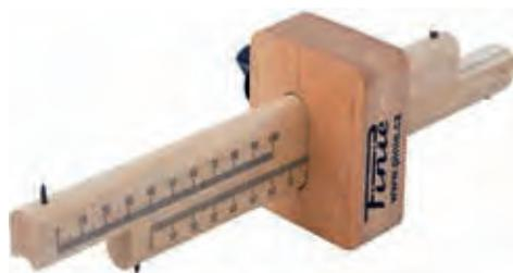
Klassisches Streichmaß aus Buchenholz mit zwei leicht verstellbaren Anreißbarmen/-stäbchen. Reißnadel aus gehärtetem Stahl. Mit gut ablesbarer Skala in Millimeter. Wahlweise mit einer (PI-41-1) oder zwei (PI-41-3) Feststellschrauben.
