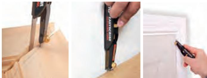
Der Easyscribe ist ein innovativer Transferstift, um Konturen von Profilen auf andere Werkstücke zu übertragen und das egal wie dünn der Spalt oder wie verzwickelt die zu übertragende Form ist. Verschiedene Funktionen wie parallel, konvex, Konturen, uvm. sind möglich.
