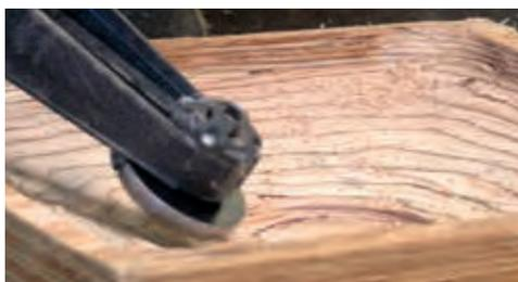
2 Hartmetallschneiden. 10 mm Schnitttiefe. 4 mm Schnittbreite. Nachschärfbar mit Diamantfeile.
