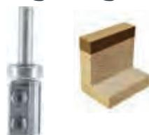
Wendeplattenfräser ein- oder zweischneidig (vierseitig verwendbar), umfang- und stirnschneidend und mit auswechselbarem Kugellager.
