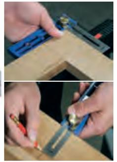
Multifunktionales Markier- und Messwerkzeug zum Anreißen von Gehrungswinkeln oder Ausrichten eines Bildes. Skala in Zoll und Millimeter.
