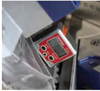
Digitales Winkelmessgerät, magnetisch zum Messen des Neigungswinkels von Kreissägeblättern. Mit praktischer „Hold“ Funktion.
