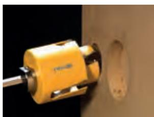
Vergrößerung einer Bohrung
