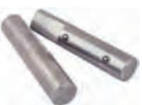
Ein Paar Hobelbankhaken aus Aluminium. Durch eine federgespannte Stahlkugel wird der Hobelbankhaken fest in der Aufnahmebohrung der Arbeitsplatte oder des Untergestells fixiert. Wahlweise in  $\varnothing$  19 mm.
