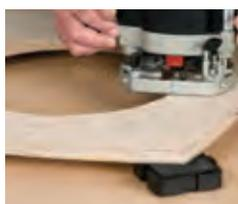
Zum sicheren Halten von Werkstücken beim Fräsen, Schleifen, etc. Blöcke können miteinander durch Einklicken verbunden werden.
