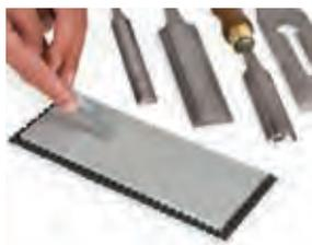
Konventionelle Schärfe steine schleifen sich hohl, Diamant-Platten bleiben plan. Die Spiegelseite von Hobeisen und Stemmeisen können Sie auf einer Schleifmaschine nicht abrichten. Diese Arbeit können Sie jedoch sehr gut auf einem Diamant-Stein ausführen. Hier gibt es Einzelsteine, aber auch Sets und Systeme mit sehr gutem Preis-/Leistungs-verhältnis.
