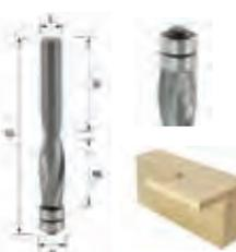
Der aus Vollhartmetall gefertigte Bündigfräser mit doppeltem Kugellager ist spiralgenutet und erzeugt beim Fräsen eine saubere Fräskante, sowie einen perfekten Schnitt. Bei dem doppelt gelagerten VHM-Fräser kann mit einem höheren Seitendruck, als bei herkömmlichen Fräsern, gearbeitet werden.
