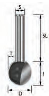
Zweischneidiger Kugelfräser zur Herstellung von unten liegenden runden Nuten, z.B. bei Kabelkanälen. Wird der Fräser mit voller Nuttiefe eingesetzt, muss zunächst eine Nut vorgefräst werden.
