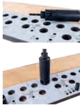
Die Lochreihenbohrschablone zum exakten Bohren von Dübellöchern im 32er-Raster, sowie Bohrungen für Türbänder, Regalbodenträger oder Dübelverbindungen im  $\varnothing$  3,5 mm oder 8 mm. Die Schablone ist aus hochwertigem Pertinax gefertigt und misst 900 mm. 3 mm oder 8 mm Dübelbohrer müssen separat bestellt werden.
