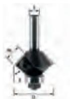
Wendeplatten-Fasefräser mit zwei achsparallelen Hartmetallschneiden, umfangschneidend, sowie auswechselbarem Kugellager.
