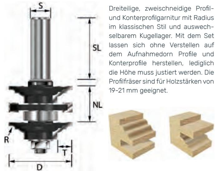
Dreiteilige, zweischneidige Profil- und Konterprofilgarnitur mit Radius im klassischen Stil und auswechselbarem Kugellager. Mit dem Set lassen sich ohne Verstellen auf dem Aufnahmedorn Profile und Konterprofile herstellen, lediglich die Höhe muss justiert werden. Die Profilfräser sind für Holzstärken von 19-21 mm geeignet.
