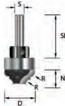
Ein Karnisnutenfräser mit klassischem Profil mit auswechselbarem Kugellager. Er ist mit zwei HM-Schneiden bestückt und zum Einbohren geeignet.
