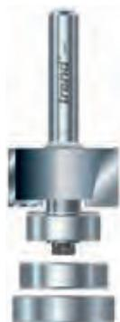
Zweischneidiger Falzfräser mit drei auswechselbaren Kugellagern. Die Falztiefen betragen je nach Kugellager 1 mm, 2,5 mm, bzw. 4 mm.
