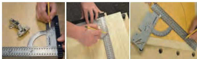
Variabel einsetzbare Schreinerwinkel zum Anreißen von Rafix-Korpusverbindern, Kreisbögen etc. Zahlreiche Lochbohrungen ermöglichen einen variablen Einsatz als Bohrschablone, z.B. für Lochbohrungen im 32 mm-Raster.
