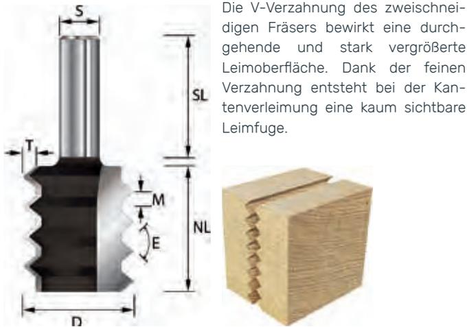
Die V-Verzahnung des zweischneidigen Fräasers bewirkt eine durchgehende und stark vergrößerte Leimoberfläche. Dank der feinen Verzahnung entsteht bei der Kantenverleimung eine kaum sichtbare Leimfuge.
