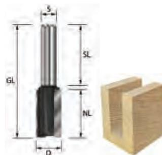
Zweischneidiger Nutfräser zum Nuten, Falzen, Langlochfräsen und Bohren (grund- und flankenschneidend). Der Nutfräser sorgt für ausrissfreie Kanten und ist bedingt geeignet zum Einbohren (z.B. in Weichholz). Zum Einbohren empfehlen wir die Nutfräser mit HW-Bohrschneide (Z = 2+1).
