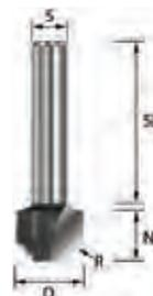
Ein 2-schneidiger Nutenprofilfräser mit Viertelstabprofil und breiter Nut an der Unterseite.
