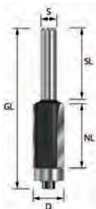
Bündigfräser zur präzisen Bearbeitung von Kanten mit dem exakt passenden **Kugellager an der Schneide**. Die Bündigfräser sind auch sehr gut geeignet zum Arbeiten mit Schablonen. Auch Kunststoffe wie Acrylglas lassen sich mit den Bündigfräsern sehr gut bearbeiten.
