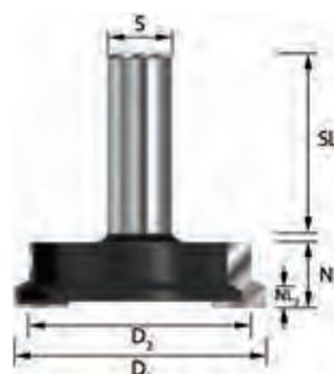
Der Fräser wird insbesondere beim Verleimen für Schubladen oder Holzkisten verwendet. Der Fräser vergrößert die zu verleimende Fläche und sorgt damit für zusätzliche Stabilität.
