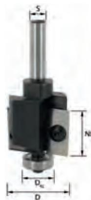
Zweischneidiger Wendeplatten-Falzfrä- ser, der mit drei Kugellager geliefert wird. Durch den einfachen Austausch des Kugellagers verändert sich die Falztiefe ent- sprechend.
