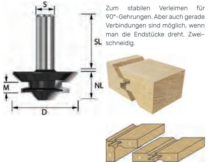
Zum stabilen Verleimen für 90°-Gehrungen. Aber auch gerade Verbindungen sind möglich, wenn man die Endstücke dreht. Zweischneidig.
