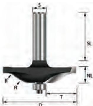
Zweischneidiger Abplattfräser mit Karnisprofil und auswechselbarem Kugellager. Möglich sind Profiltiefen von 19 und 28,5 mm. Beim Schaft-8-mm-Abplattfräser sollte in mehreren Arbeitsschritten gefräst werden, um Bruchgefahr zu vermeiden. Die empfohlene Schnittgeschwindigkeit beträgt maximal 12.000 U/min.
