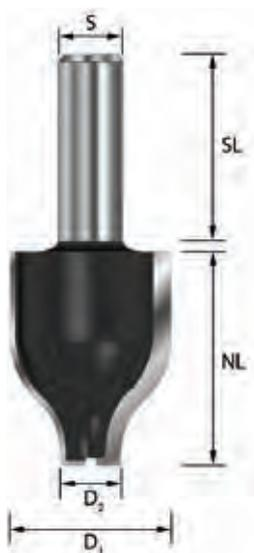
Der zweischneidige Abplattfräser mit Radius 16 mm wird zur vertikalen Bearbeitung von Werkstücken verwendet. Der vertikale Abplattfräser erreicht bei kleinerem Durchmesser eine größere Abplatttiefe. Besonders geeignet ist der Fräser, wenn die Bearbeitung durch eine Oberfräse mit kleinerer Öffnung erfolgt. Die Arbeitstiefe von 41,3 mm sollte hierbei in 2 bis 3 Arbeitsschritten durchgeführt werden.
