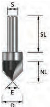
Dieser Fräser eignet sich besonders bei Arbeiten mit Schablone, da das Kugellager den gleichen Durchmesser wie die Schneiden besitzt. Die V-Nut ist HM-bestückt mit 2 Schneiden. Der Nutgrund ist etwa 1 mm breit und flach.
