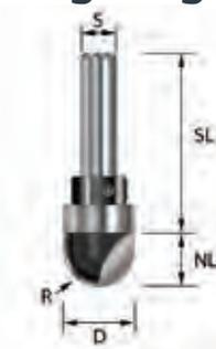
Dank Kugellager am Schaft dieses 2-schneidigen Hohlkehlfräasers eignet sich dieser besonders gut zur Bearbeitung von Werkstücken mit Schablone.
