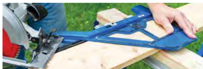
**Einfacher aber durchdachter Anschlag für die Hand- oder Tauchkreissäge.**
