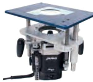
OFL mit montierter Oberfräse.
