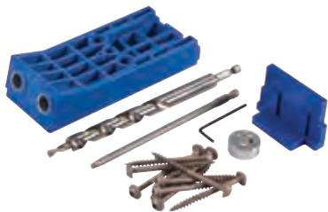
HD „Heavy Duty“. Diese Bohrschablone ist für größere Projekte optimiert und erzeugt 50% stärkere Verbindungen, als das reguläre Kreg Jig. Verwendbar mit K4, K4 Master System und K5-System. Werkstückstärken 38 bis 50 mm.
