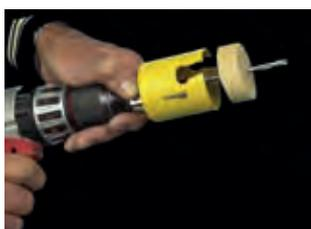
Einfaches Entfernen des Sägekerns
