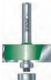
Zweischneidiger Falzfräser mit zwei auswechselbaren Kugellagern. Die Falztiefen betragen je nach Kugellager 11,1 bzw. 12,7 mm.
