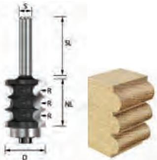
Profilfräser, HM-bestückt, mit konvexem Radius zum dekorativen Fräsen und Kantenbearbeiten von einem, zwei oder drei Profilen in einem Arbeitsgang.
