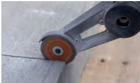
Geeignet zum Schneiden oder Schleifen von Fliesen, Steinen und den meisten Mauerwerksprodukten, sowie zum Schärfen und Schleifen von Hartmetall.
