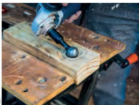
Der Ball Gauge ist ein sphärisch geformter Schleiferaufsatz, der schnell hohle, kleine, konkave Flächen in Holzbearbeitungsprojekten herstellen kann. Er wurde speziell entworfen, um außergewöhnliche Kontrolle, Balance und Leistung in der Freihand-Holzformung und beim Schnitzen zu bieten.
