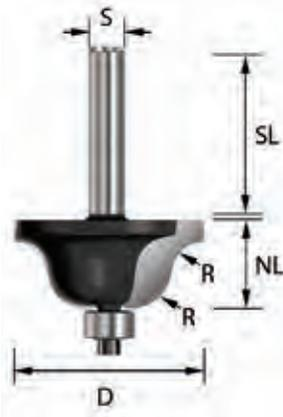
Zweischneidiger Profilfräser mit zwei identischen Radien, ohne Falz. Hartmetall-bestückt. Römisches Profil. Mit auswechselbarem Kugellager.
