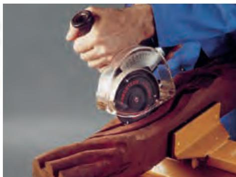
Dank der äußerst glatten Oberfläche ist der Woodcarver Industrial ideal für den Hohlschliff geeignet. Hervorragendes Schnittgefühl und lange Lebensdauer. Äußerst rückschlagarm. Die Frässhleibe ist auch im Set erhältlich, inklusive Schutzhaube für sicheres Arbeiten. Passend für alle 100 mm und 115 mm Winkelschleifer. Die Hartmetallzähne können ausgetauscht werden.
