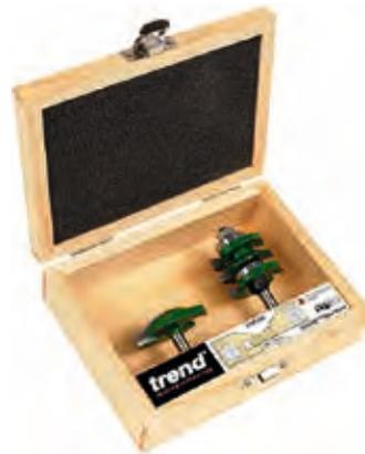
3-teiliges HM-**Profil-Fräser**-Set mit passendem Abplattfräser in dekorativer Holzkassette. Der Konterprofilfräser muss zum Fräsen des Konterprofils nicht umgebaut bzw. umgesteckt werden, sondern nur in der Höhe im Frästisch verändert werden. Vorteile sind Zeitersparnis und vor allem Präzision.
