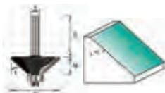
Zweischneidiger Fasefräser mit auswechselbarem Kugellager. Durch den 45°-Winkel und eine längere Schneidenlänge eignet sich dieser Fräser auch für größere Anfasungen.
