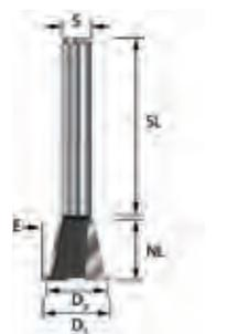
Zweischneidige Zinkenfräser und Gratfräser zum Fräsen von Schwalbenschwanzverbindungen. Mit Vorschneider, aber ohne Kugellager.
