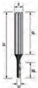
Dieser einschneidige Nutfräser ist speziell für schnelle Vorschübe geeignet, wenn die Nutkanten nicht zwingend ausrissfrei sein müssen. Besonders geeignet ist der Fräser zum Nuten, Falzen, Langlochfräsen und Bohren.
