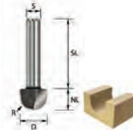
Für perfekte Rundungen in einer Nut eignet sich dieser HM-bestückte Hohlkehlfräser. Die zwei Schneiden ermöglichen ein sauberes Fräsen der Nut (bohr- und umfangschneidend). Mit den Radien 19,05 und 25,4 mm lassen sich zudem Treppenhandläufe fräsen.
