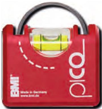
Maßstab und Wasserwaage in Einem! Das ein Meter lange Edelstahlmaßband lässt sich gestreckt im Gehäuse arretieren und funktioniert damit als Wasserwaage mit Skala. Wird das Band nicht gebraucht, lässt es sich sicher und kompakt in das Gehäuse einrollen. Am Gehäuse befindet sich ein Magnet, um den Pico auf Metalloberflächen sicher zu befestigen.
